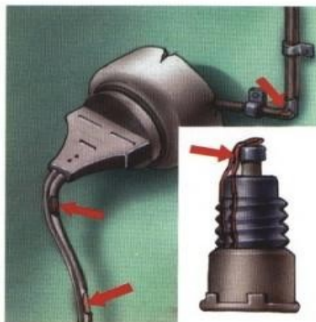
Неисправность электропроводки Пользование самодельными предохранителями
